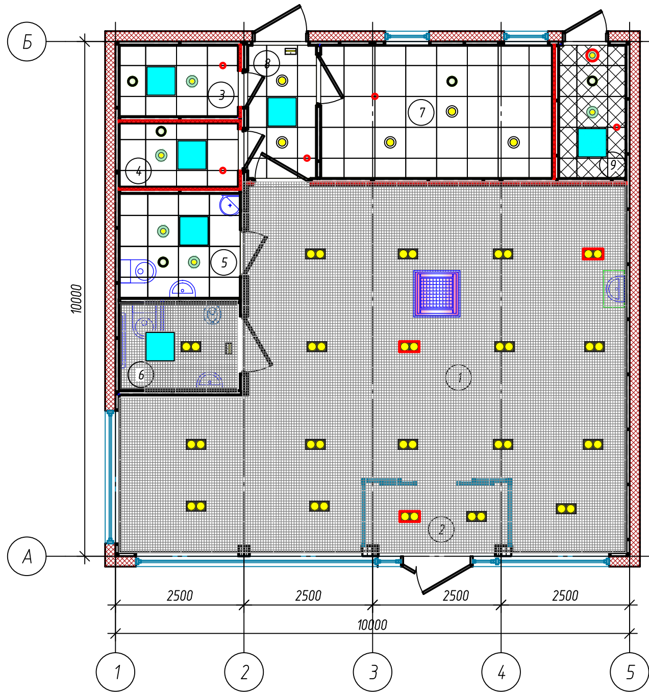
План потолка здания модификации Sm100
